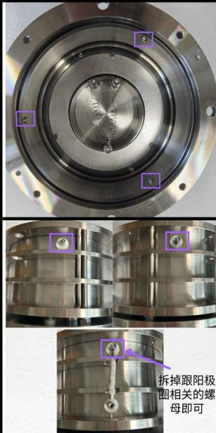
拆掉紫色框中螺钉、螺母和陶瓷，取出阳极圈
