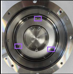
接着拆掉紫色框所圈的固定螺钉，取出阳极片。
