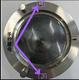
拆掉箭头所指的手拧螺母，取下栅网，露出离子源内部。
